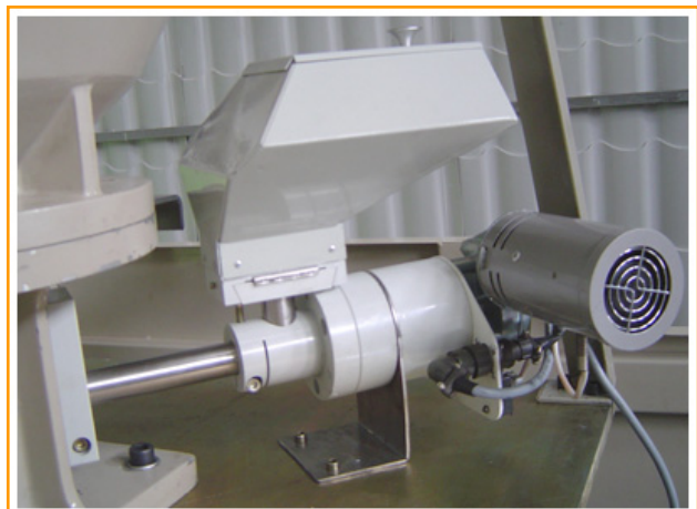
рис.2 Фотография дозатора установленного на термопластавтомат
